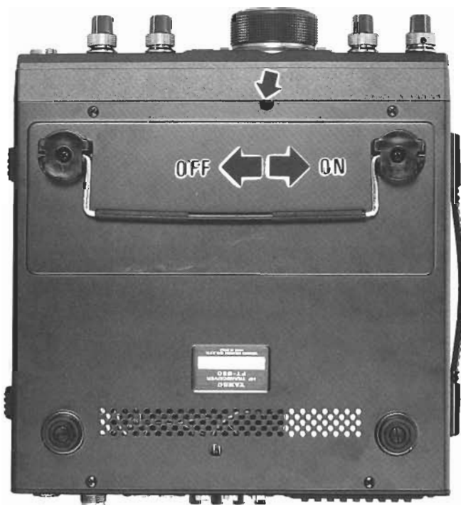
写真 3 バックアップ用リチウム電池の ON/OFF スイッチ
