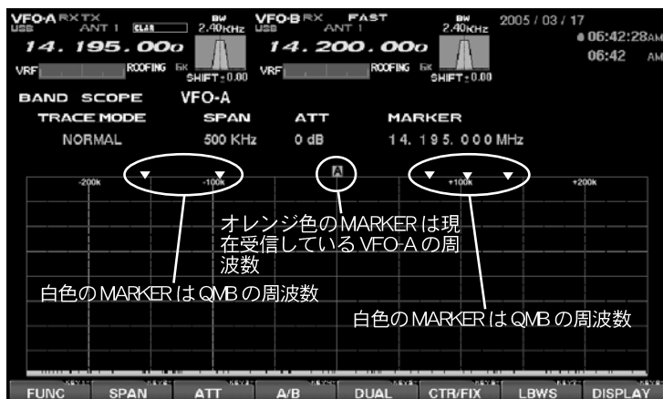
上図は14MHz帯に5チャンネルのQMB MARKERを表示されている例
