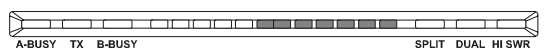
受信周波数と送信周波数のオフセット量がプラスの場合
