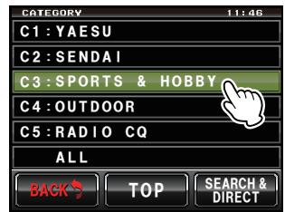
セットモードの“WIRES”→“2 SEARCH SETUP”で、一覧の表示順をアクティビティ順またはアクセス履歴順から選べます。
