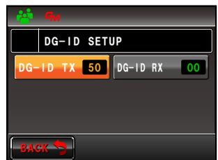
4. [BACK]にタッチした後に、画面の[DG-ID RX]にタッチします。
