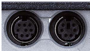
●CAT/LINEAR端子(左)とDATA端子(右)
