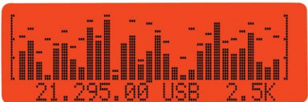
●左のバーグラフがSWR表示。上のSWRは、SWRが高い時に警告表示
