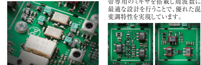
標準装備の3kHz/15kHzルーフィングフィルタ HF/50MHz帯用クワッドミキサ VHF/UHF帯用ミキサ
