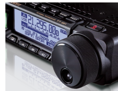
トルクコントロール付大型チューニングダイヤル
