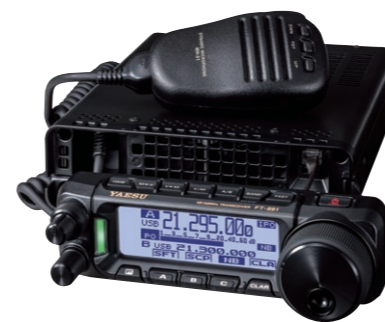
トルクコントロール付大型チューニングダイヤル
