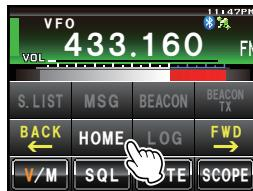
もう一度[HOME]にタッチするとVFOモードに戻り、ホームチャンネルを呼び出す前に選択していた周波数がディスプレイに表示されます。
