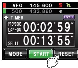
【RECALL】にタッチすると、過去に計測したラップタイムが表示されます。ラップタイムが複数ある場合は、【▲】【▼】にタッチすると切り替えられます。
