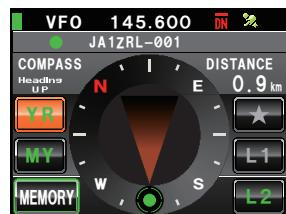
**COMPASS** コンパスの設定を表示します。自局の進行方向が上方となる「Heading Up」と北が常に上方となる「North Up」があります。
